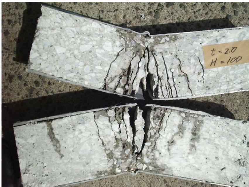
写真-1.1 コンクリート充填鋼管はりの破断
